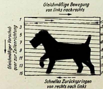
Bild 2. Abtasten eines ebenen Bildes zur elektrischen Übertragung
