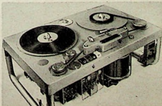
Bedienungsplatte des AEG-Magnetophons T 9 für Rundfunkstudios
